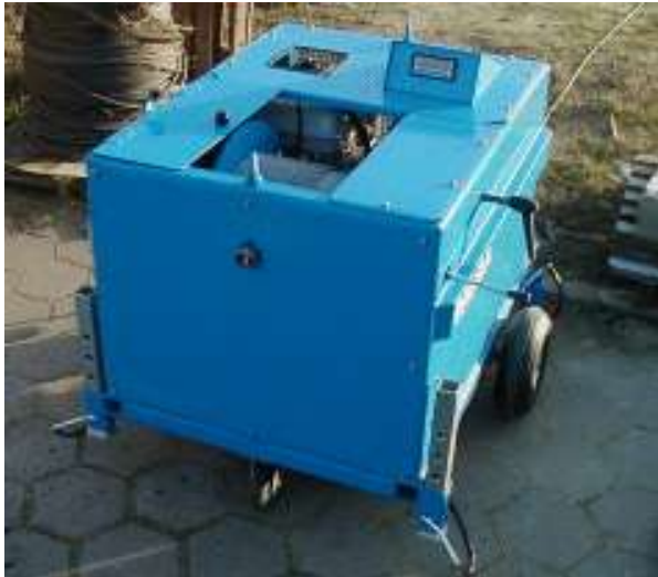
KTW 1000 benzinmotorral és szállító kerekkel
