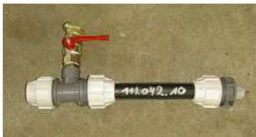
Befújó berendezés koaxiál- és üvegszálakábelhez Ø8-16 mm Device for blowing-in of coaxial and fibre-optic cable dia. 8-16 mm
