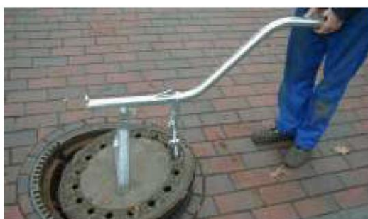
Fedélemelő fogó háromszög fogantyúval, horganyzott Manhole-cover lifting tongs with triangular support, galvanized
