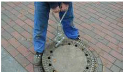
Fedélemelő fogó háromszög fogantyúval, horganyzott Manhole-cover lifting tongs with triangular handle, galvanized
